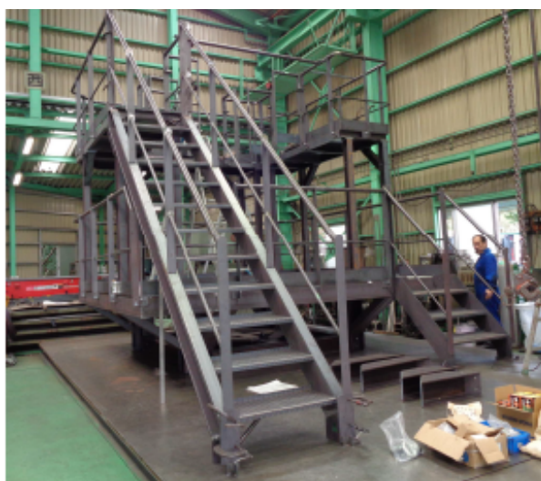
手すり・歩廊・階段
