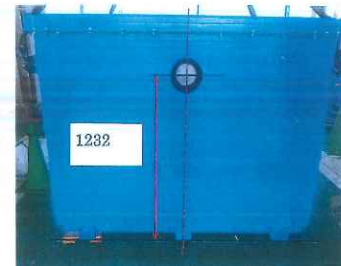
1F 粉塵吸引真空コンテナ
